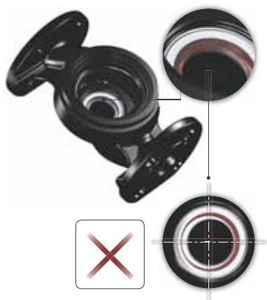
Рис. 14 Неправильне центрування системи ущільнення
