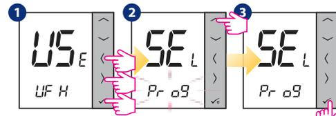
Настройка типа терморегулятора:
