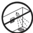
Не следует устанавливать терморегулятор в помещениях с повышенной влажностью. Термостат должен размещаться за пределами зоны 2. Разместите его в соседнем помещении и используйте режим «только датчик температуры пола». При установке терморегулятора соблюдайте местные нормы по IP-классам защиты.
