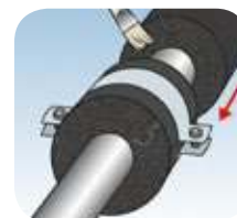
5 - Нанесите на торцевые стороны подвеса и изоляции клей для их склеивания.
