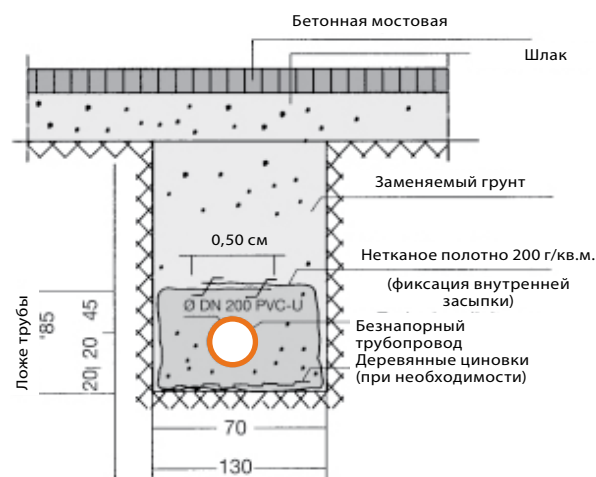
Рис. 7 Пример прокладки труб в мягком грунте
