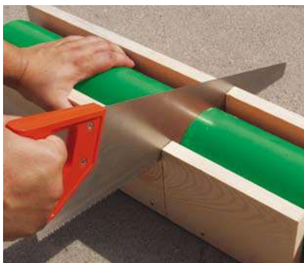
Рис. 3 Резка с использованием стусла
