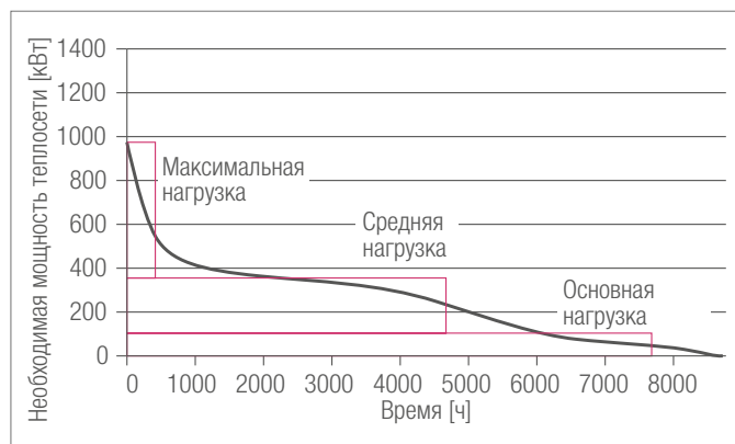
Рис. 6-11 Упорядоченный годовой график для модульных теплогенераторов
