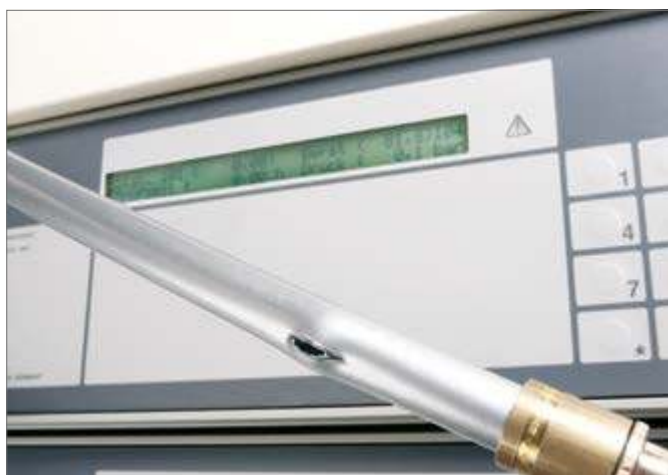
Рис. 3-5 Испытание на прочность при действии внутреннего давления
