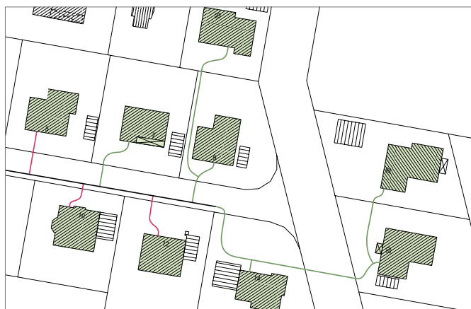
Рис. 6-6 Сочетание различных систем прокладки труб
