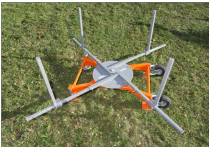
Рис. 7-24 Стационарное горизонтальное размоточное устройство в конце траншеи.
