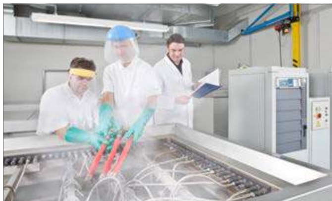
Рис. 6-18 Непроницаемость труб проверяется в ходе длительного испытания
