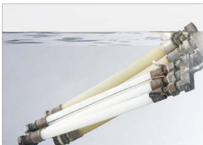
Рис. 3-6 Испытание на непроницаемость
