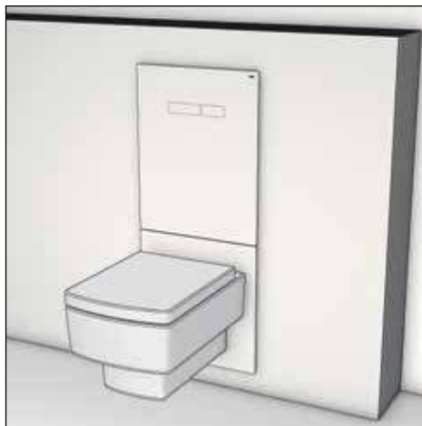
(6) Монтаж верхней стеклянной панели. Сборка завершена.
