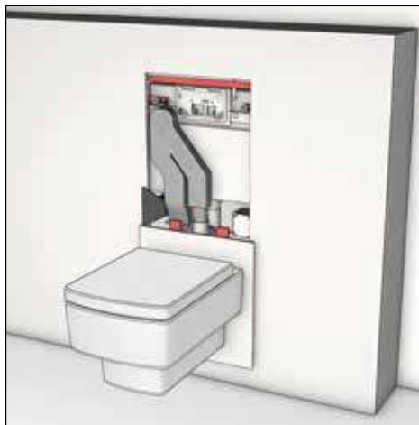
(5) Монтаж нижней стеклянной панели и унитаза.
