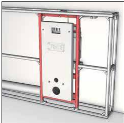
(2) Установка шаблона для отделки отверстия в стене.
