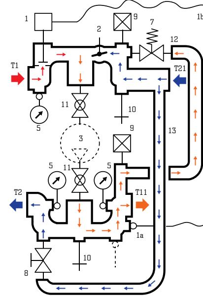
Теплоноситель первичного контура T1 поступает в насосно-смесительный узел через терmostатический клапан 1. Степень открытия клапана автоматически регулируется терmostатической головкой в зависимости от выбранной настройки и температуры теплоносителя на подаче к коллектору теплого пола.
