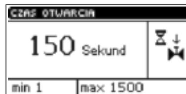
В этой функции настраивается время открытия клапана, то есть, как долго открывается клапан до значения 100%. Это время следует подобрать согласно установленному сервомотору клапана (указан на заводском щитке).
