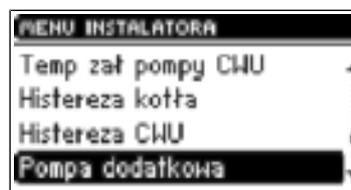
Пользователь может подключить дополнительный насос: циркуляционный или насос клапана. Затем, в зависимости от выбранного насоса, следует конфигурировать соответствующие настройки.
