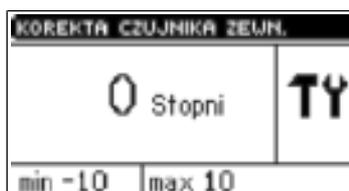
Корректировка проводится она при установке или после длительного пользования контроллером, если температура в помещении, отображаемая на датчике, отличается от фактической. Диапазон регулировки: от -10 до +10 ОС.
