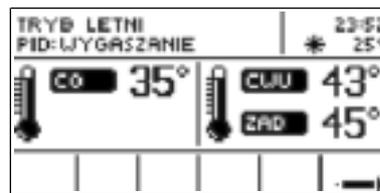
В летнем режиме устанавливается только заданная температура на котле, который нагревает воду в бойлере (заданная температура котла является одновременно заданной температурой бойлера). После включения летней функции на дисплее появится фактическая температура Ц.О. и две темп. Г.В.С. (фактическая и заданная).
