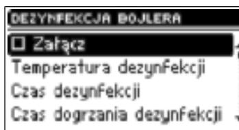
Термическая дезинфекция состоит в повышении температуры до требуемой температуры для дезинфекции - мин. 60°C во всей системе горячего водоснабжения.
