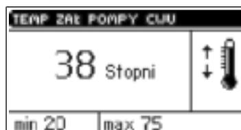
Этот режим служит для настройки температуры включения насоса гор. воды. (это температура, измеряемая на котле). Выше настроенной температуры (напр. 38°C) включается насос и работает в зависимости от избранного режима работы. Выключение насоса произойдет после понижения температуры на котле ниже температуры включения (минус гистерезис гор. воды 2°C), в этом случае насос выключится при 36°C на котле.
