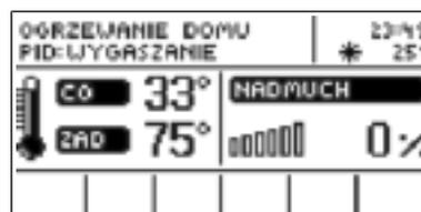
Выбирая эту функцию, регулятор переходит в состояние отопления только дома. Насос ц.о. начинает работать выше предела включения насосов (установленный производителем на 40°C - см. раздел). Ниже это температуры насос перестает работать (минус 2°C- гистерезис ц.о.).
