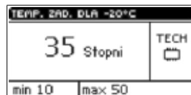
При помощи этого параметра можно настраивать заданную температуру клапана для соответствующих значений наружной температуры. На основании
