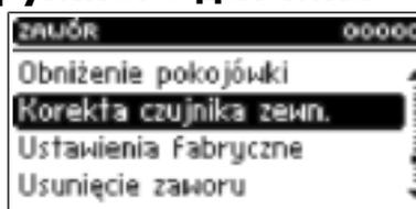
Корректировка наружного датчика проводится при установке или после длительного пользования регулятором, если температура в помещении, отображаемая на датчике, отличается от фактической. Диапазон регулировки: от -10 до +10 °C с точностью до 1°C.
