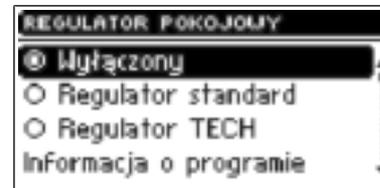
При помощи этой настройки пользователь может выключить или включить соответствующий вид комнатного регулятора, выбирая между стандартным регулятором (традиционным двухуровневым) и регулятором TECH (со связью RS и возможностью настройки заданных температур).
