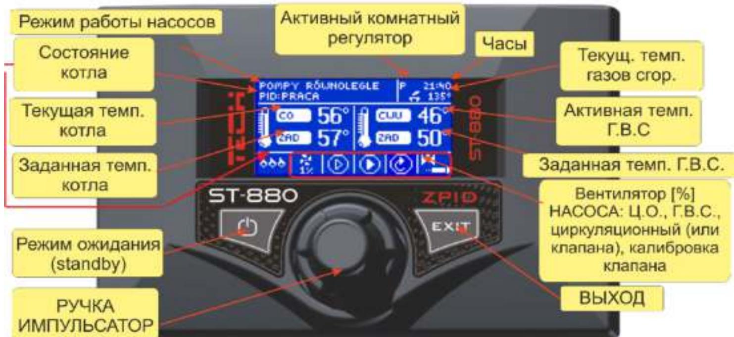
Регулятор температуры **ST880** предназначен для котлов ц.о. и управляет насосом циркуляции воды Ц.О., насосом горячего водоснабжения ГВС, клапаном-смесителем и вентилятором. Дополнительно есть возможность управлять еще двумя клапанами-смесителями посредством модулей ST-61.
