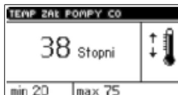
Этот режим служит для настройки температуры включения насоса ц.о. (это температура, измеряемая на котле). Выше настроенной температуры включается насос. Выключение насоса произойдет после понижения температуре на котле ниже температуры включения (минус гистерезис 2°C).
