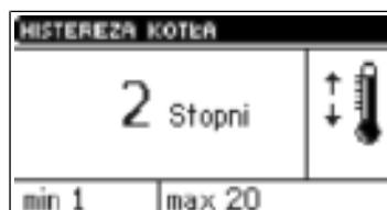
Этот режим служит для установки гистерезиса заданной температуры Ц.О. Это разница между температурой входа в цикл поддержки и температурой возврата в рабочий цикл (напр. когда заданная температура установлена на 60°C, а гистерезис составляет 3°C, переход в цикл поддержки наступит после достижения температуры 60°C, а возврат в цикл работы наступит после понижения температуры до 57°C).
