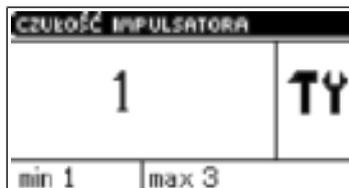
При помощи этой настройки можно изменить чувствительность ручки импульсатора в пределе от 1 до 3 (где 1 - наивысшая чувствительность).
