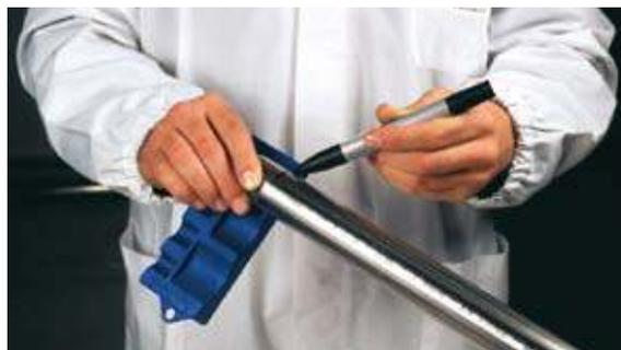
Рис. 18 Обозначение глубины введения трубы в пресс-фитинг
