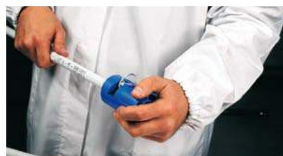
**Рис. 19 Зачистка (труба Steelpres в изоляции)**
