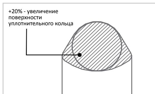
Рис. 6 Профиль уплотнительного кольца
