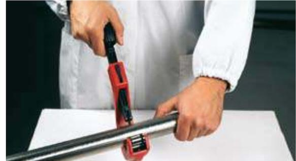
Рис. 15 Отрезание трубы
