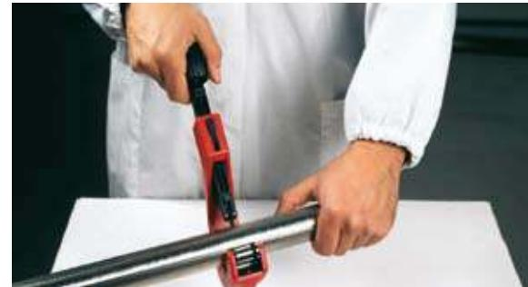
*Рис. 15 Отрезание трубы*
