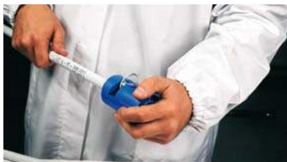
Рис. 19 Зачистка (труба Steelpres в изоляции)
