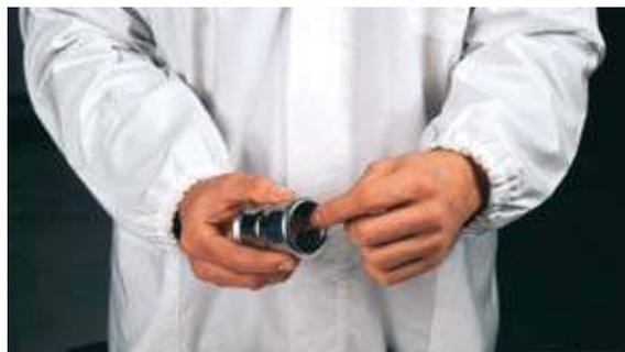
Рис. 20 Проверка расположения уплотнительного кольца
