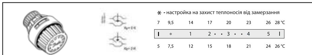
Температурні шкали складені при  $X_p = 2$  °C відповідно до Європейських стандартів. Це означає, що клапан терморегулятора закриється
