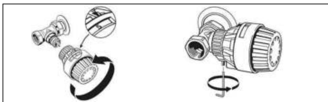
Термостатичні елементи RA 2920 і RA 2922 монтують на корпус клапана у такій послідовності:
