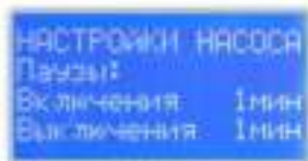
Рис. 14 – Экран настройки режима работы циркуляционного насоса
