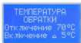
Рис. 12 – Настройка температуры обратки теплоносителя
