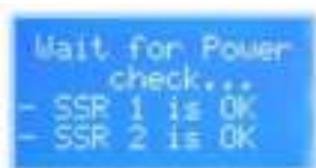
Рис. 7 – Экран проверки питания и твердотельных реле (SSR)
