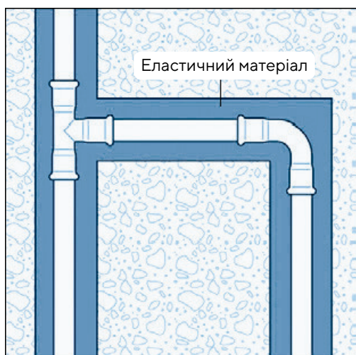
Рис. 7. Скрите прокладання трубопроводу
