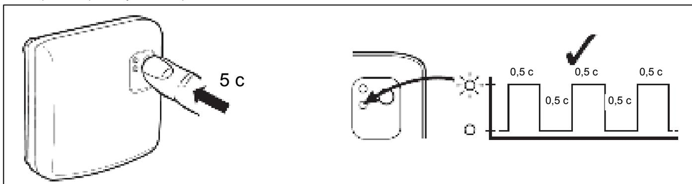
Релейный блок BDR91 останется в режиме установки радиосвязи в течение 3 минут, а затем выдаст сообщение об ошибке, если инструкции по установке радиосвязи не были получены.
