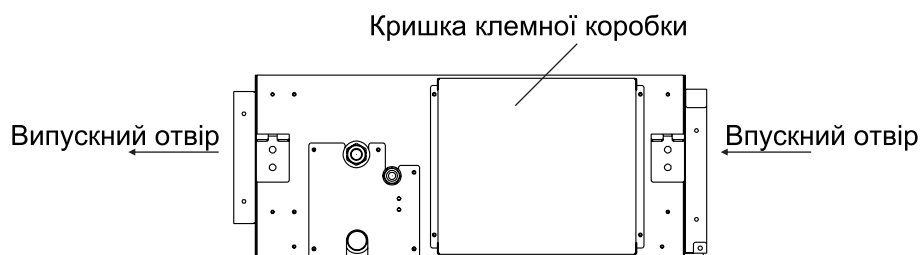
Рис. 6.1 Відкручування гвинтів на клемній коробці.
