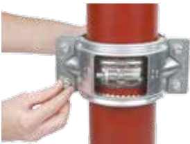
Усиливающий хомут должен быть расположен таким образом, чтобы центры закрывающих частей соединителя находились в выемках и чтобы кончики зажима находились на трубе. Две половинки зажима с 4-мя винтами необходимо соединить, не затягивая их.
