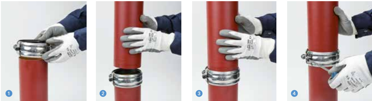
Хомут PAM GLOBAL® Rapid диаметром от 50 до 200 мм разработан для полного затягивания, что избавляет от необходимости проверять момент затяжки.
