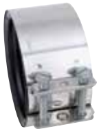
Соблюдайте моменты затяжки: Хомуты PAM CV: 8-10 Н*м для всех DN Хомуты PAM CE: 5-8 Н*м для DN 50-75/80 10-12 Н*м для DN 100-125 12-15 Н*м для DN 150-200
