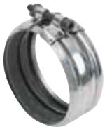
Хомут PAM GLOBAL® Rapid диаметром от 50 до 200 мм разработан для полного затягивания, что избавляет от необходимости проверять момент затяжки.
