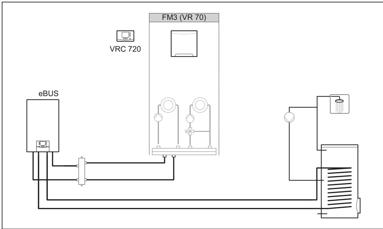
Для систем з двома опалювальними контурами, якими потрібно керувати окремо, потрібен функціональний модуль FM3.
