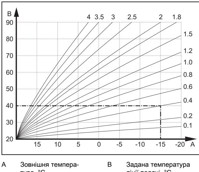
На малюнку показані можливі опалювальні криві від 0,1 до 4,0 для заданої температури приміщення 20 °C. Якщо, наприклад, вибрана опалювальна крива 0.4, то при зовнішній температурі -15°C відбувається регулювання на температуру подавальної лінії 40°C.
