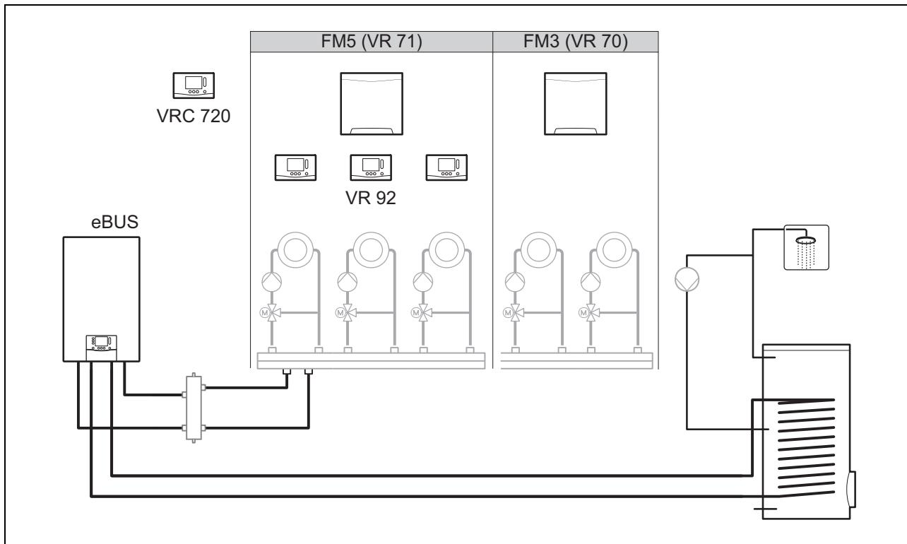
Для систем з більш ніж 2 змішаними опалювальними контурами потрібен функціональний модуль FM5.
