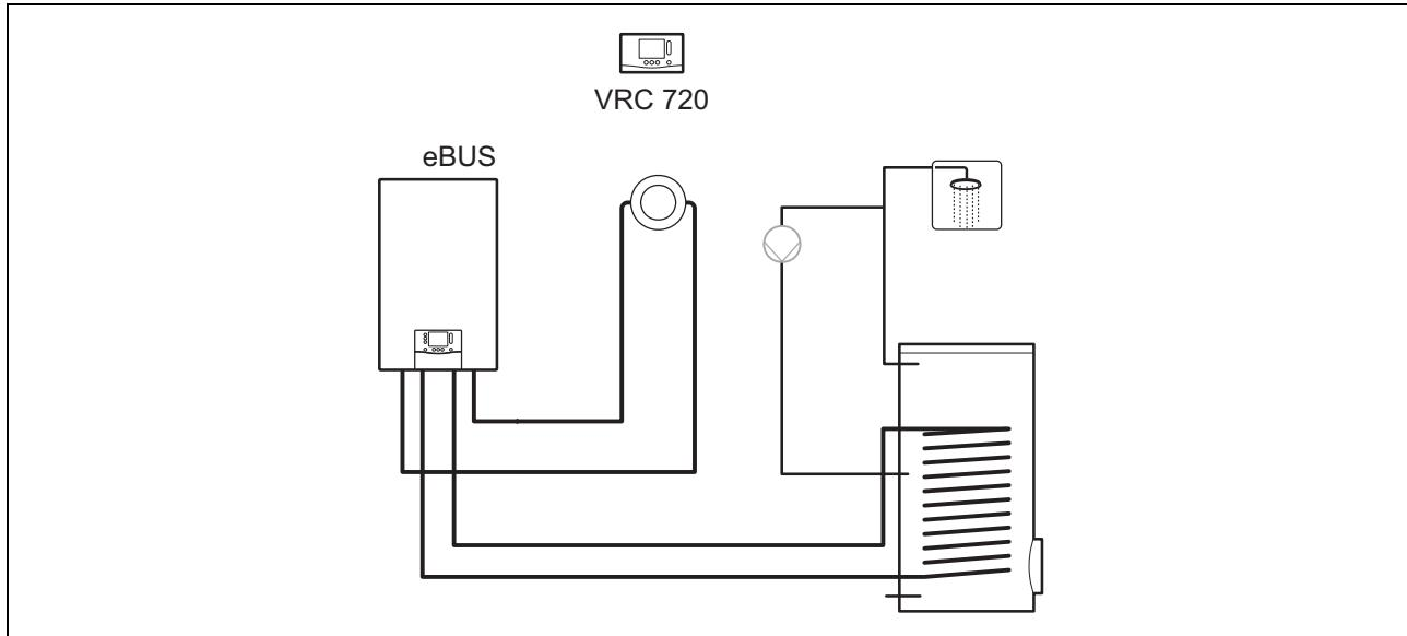
Для простих систем з прямим опалювальним контуром не потрібен функціональний модуль.
