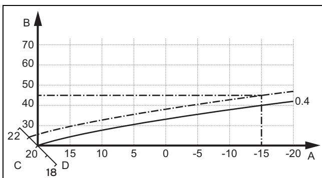
При вибраній опалювальній кривій 0,4 і заданій температурі приміщення 21 °C відбувається зсув опалювальної кривої, як показано на малюнку. На осі а, нахиленій під кутом 45°, опалювальна крива зміщується паралельно у відповідності до значення заданої температури приміщення. При зовнішній температурі -15 °C регулятор за- безпечує температуру лінії подачі 45 °C.
